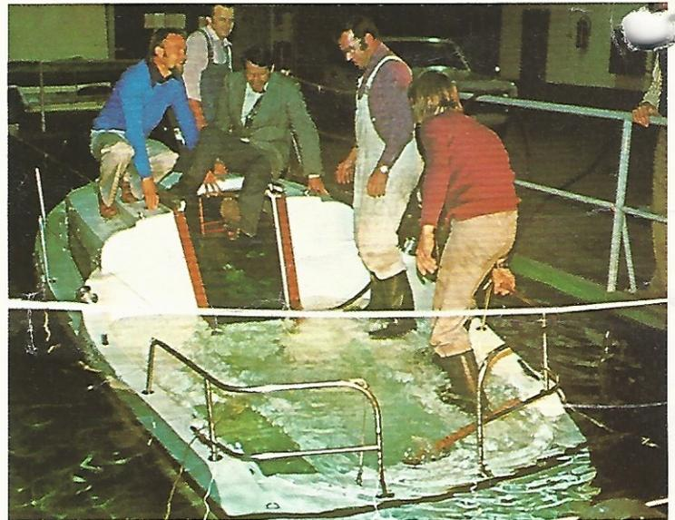
... weil die Rubin 23 unsinkbar ist. Auf Grund ihrer festeingebauten Auftriebskörper ist die Rubin 23 selbst nach großflächigen Beschädigungen des Rumpfes noch voll schwimmfähig.
